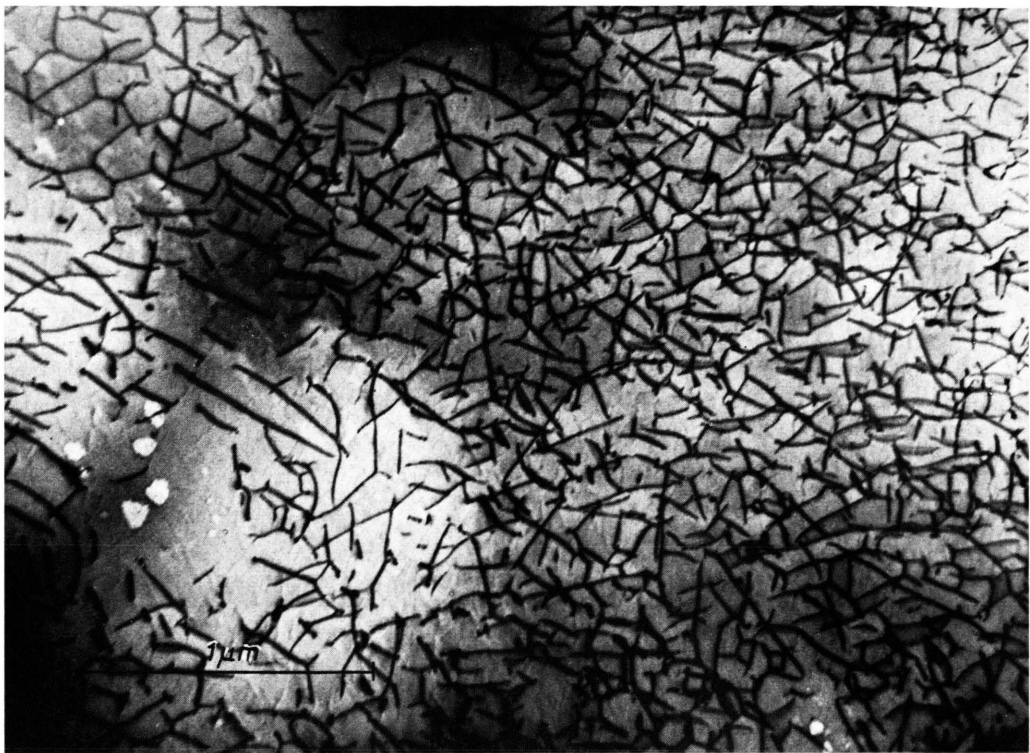
Abb. 7. „Polygonisierung“ von Versetzungsknäueln durch intensive Elektronenbestrahlung (Ar; 2,3 keV).
